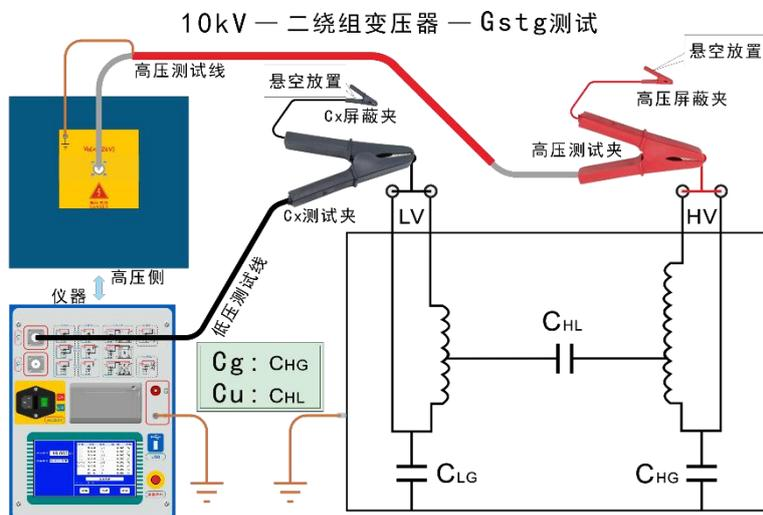
(2)、两绕组变压器  $C_{LG}+C_{LH}$  测试接线
