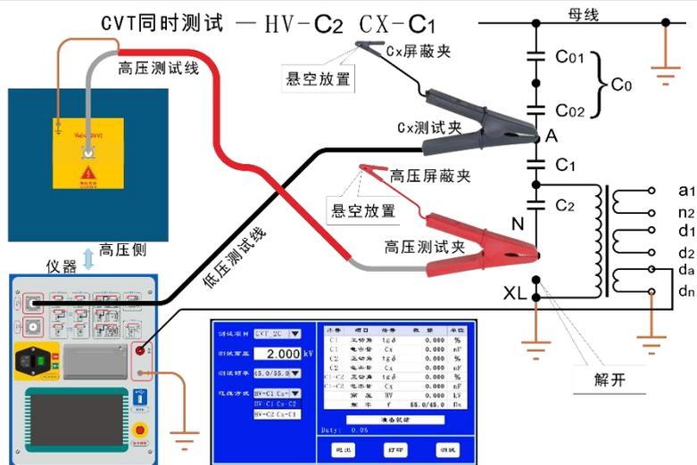
(7)、CVT 上端 C0 测试（反接法）
