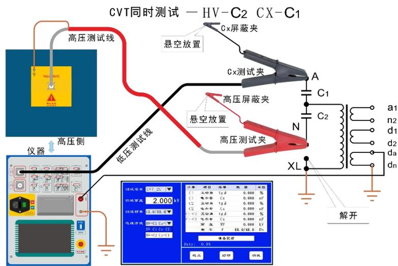
(4)、CVT 同时测试-C2C1 测试（一次完成测试）
