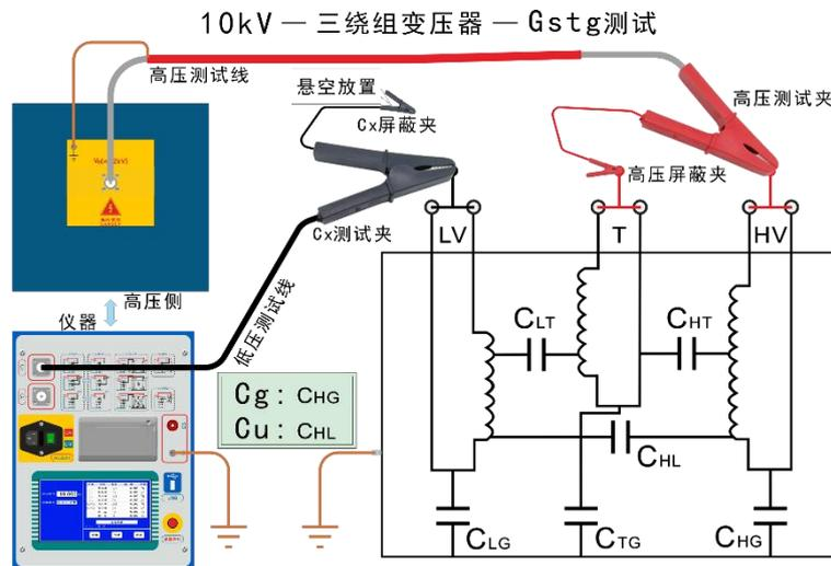
(4)、三绕组变压器  $C_{LG}+C_{LT}$  测试接线（高压线屏蔽接 HV 绕组）
