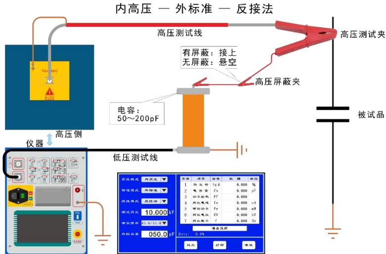
(4)、外高压—外标准—反接法 ( $50\text{pF} \leq C_N \leq 200\text{pF}$ ; 外接输入高压 HV  $< 12\text{kV}$ )
