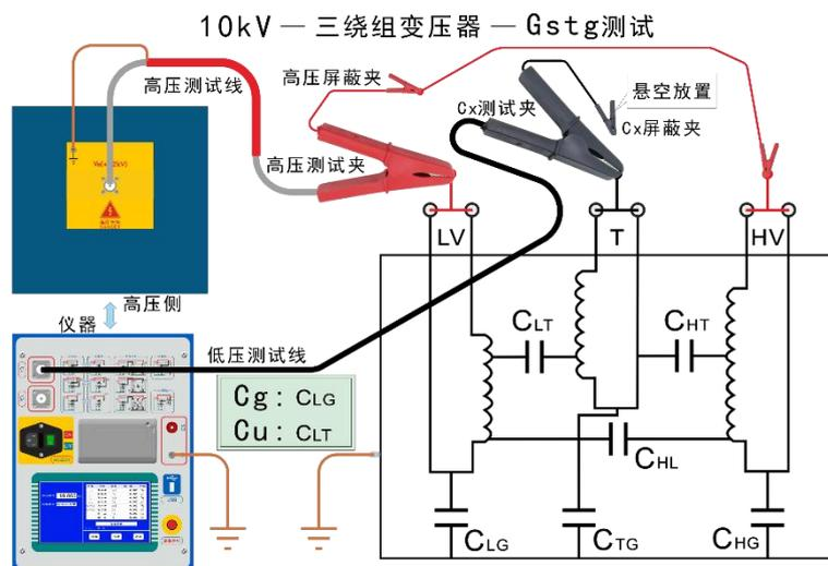
(5)、三绕组变压器  $C_{TG}+C_{HT}$  测试接线（高压线屏蔽接 LV 绕组）
