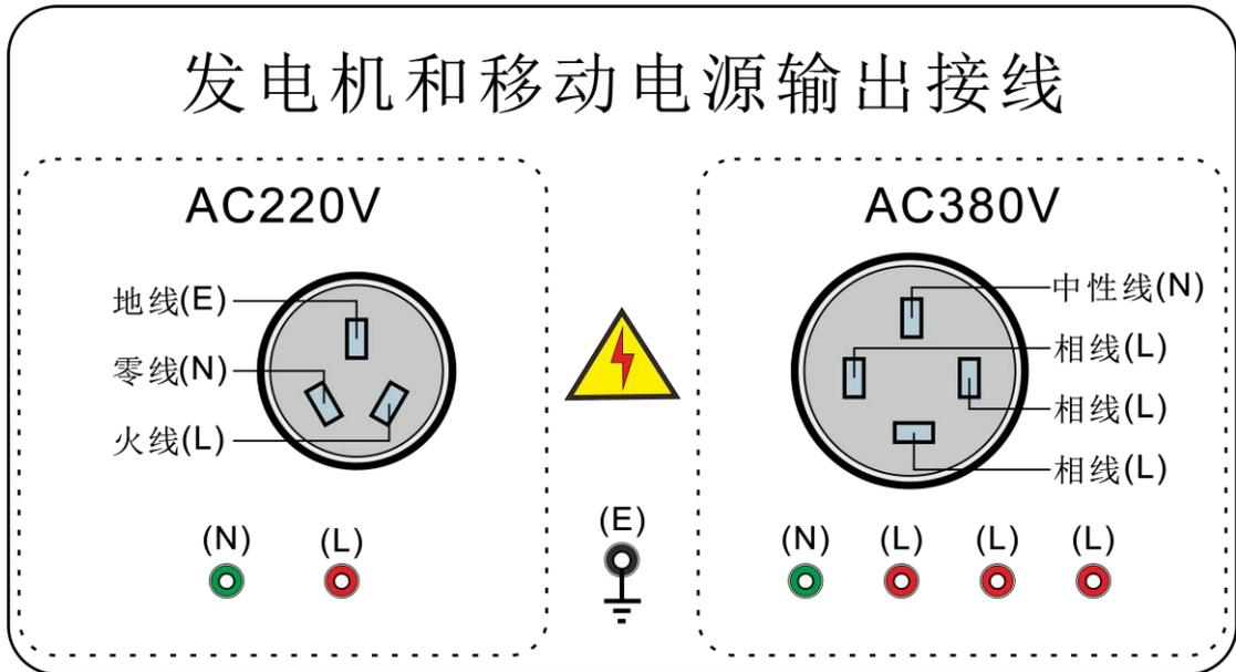
仪器做试验接市电 AC220V 不方便时，需要接发电机或者移动电源作为供电电源使用，按照平常接线，会遇到仪器主界面上显示<接地错误>的提示。
